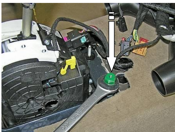
Установить шестигранный столбик на шпильку
