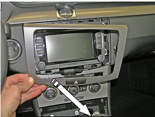
Снять декоративную планку
