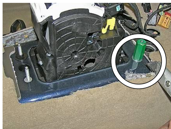
Удалить ковровин, мешающий установке замка
