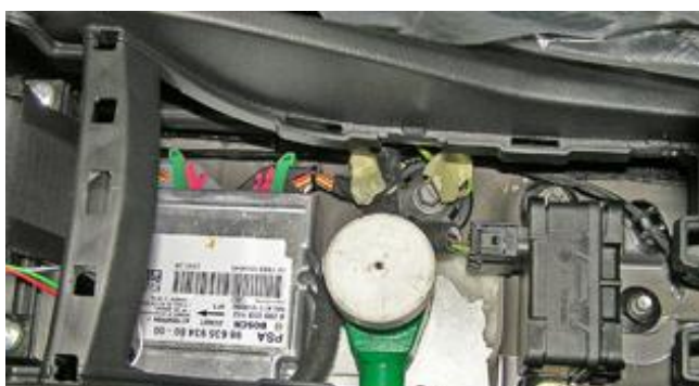
Установить консоль на место, разметить, используя разметочный шаблон, отверстие в верхней крышке под корпус замка
