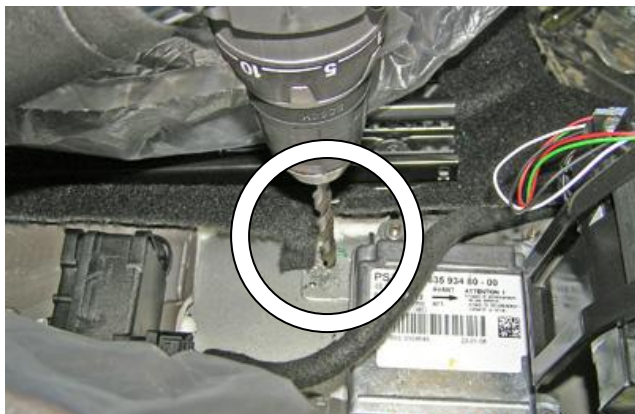
Снять замок, расширить отверстие в днище
