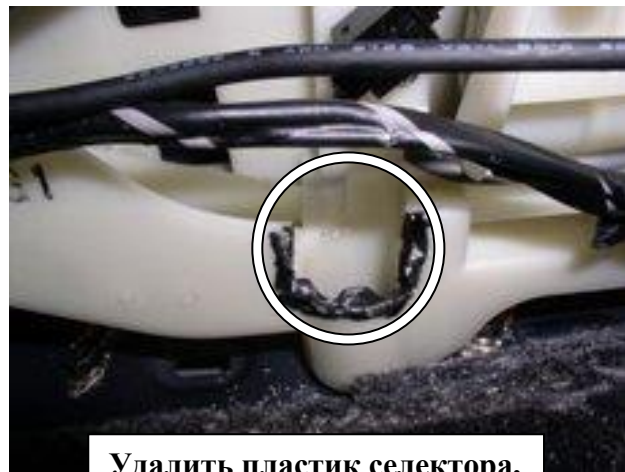
Удалить пластик селектора, мешающий установке замка
