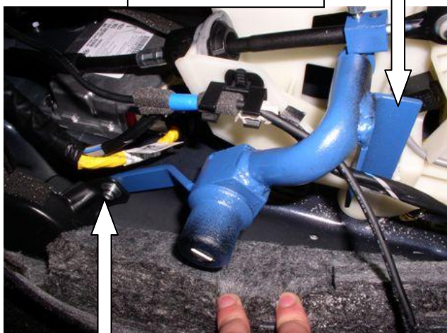
Установить замок, закрутить 2 срывных болта
