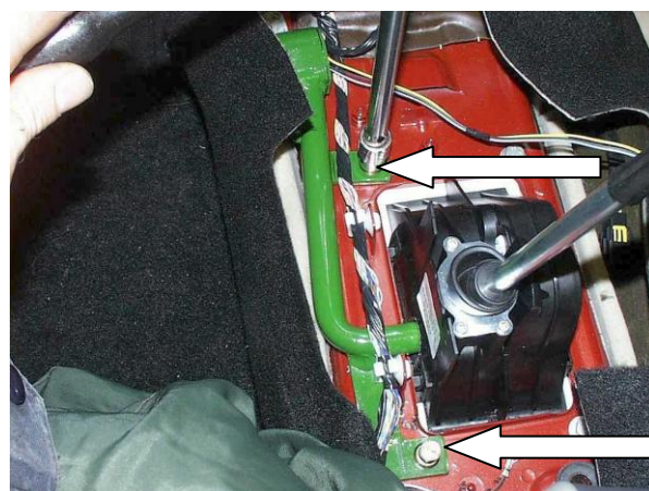
Установить замок, закрутить 2 болта
