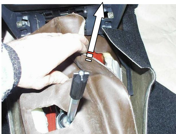
Отвернуть ковролин, снять звукоизолирующий чехол
