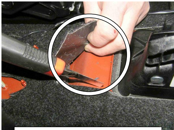
Удалить мешающую установке замка звукоизоляцию
