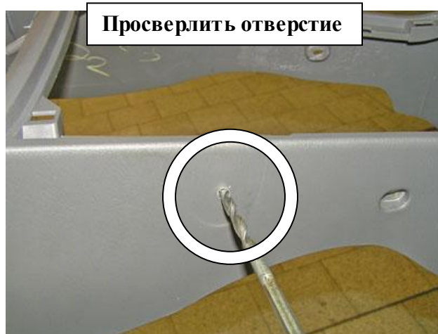
Расширить, используя разметочный шаблон, отверстие в консоли под корпус замка
