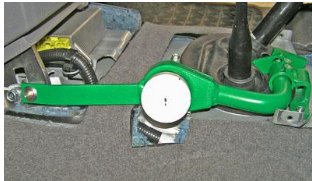
Расширить, используя разметочный шаблон, отверстие в консоли под корпус замка
