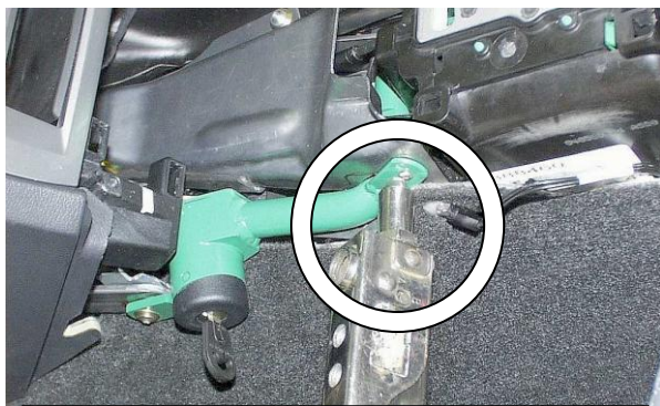
Зафиксировать замок на кожухе заклёпками, используя клёпальник
