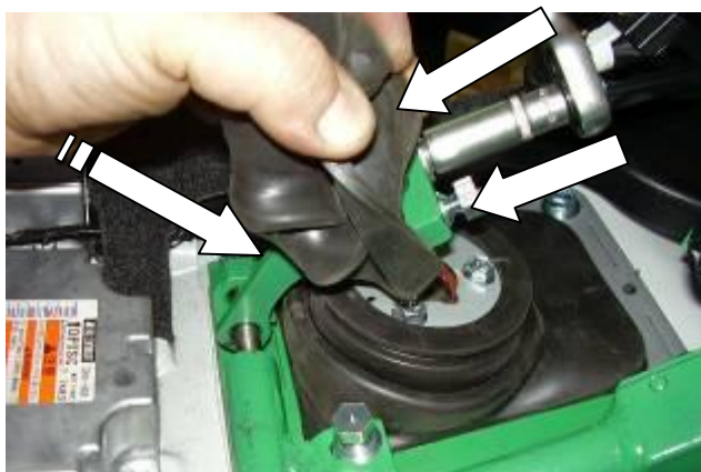
Установить хомут №1 на рычаг переключения передач, установить верхний кожух на место
