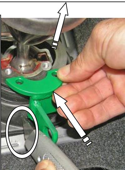
Установить хомут №1 на рычаг переключения передач, установить верхний кожух на место
