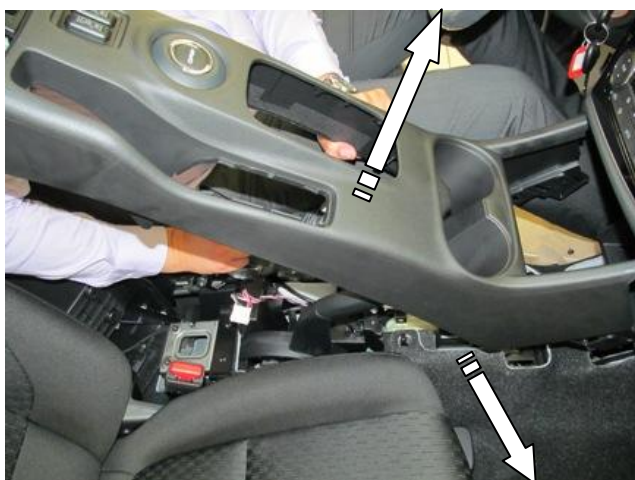
Снять переднюю консоль, снять воздуховод, отвернуть ковролин
