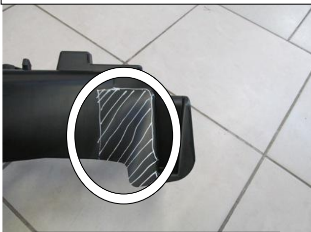
Удалить мешающий установке замка пластик держателя
