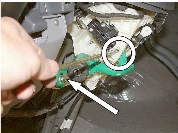
Установить замок, закрутить срывной болт, просверлить крепёжное отверстие 7 мм. в селекторе сквозь отверстие в лапке замка
