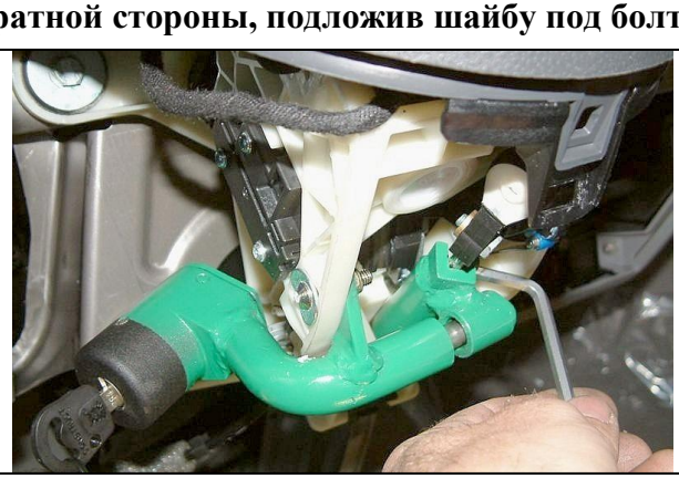
Перевести рычаг переключения передач в положение «Р», произвести блокировку, отрегулировать положение хомута на тяге, сорвать винт
