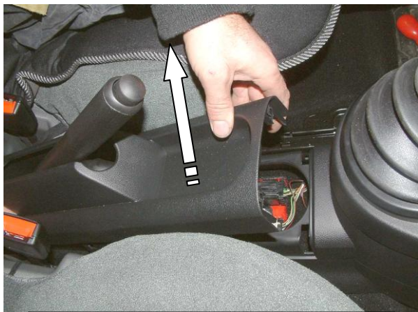
Снять верхнюю заднюю крышку
