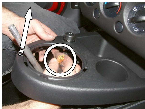
Снять верхнюю переднюю крышку, разъединить разъём
