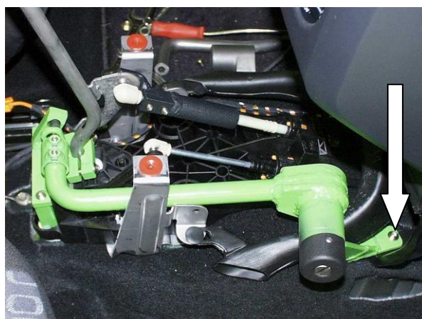
Зафиксировать лапку замка срывным болтом
