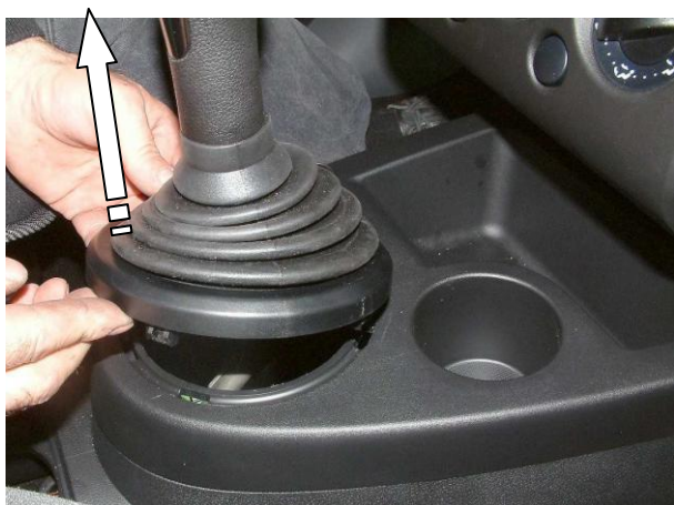
Снять декоративный чехол рычага переключения передач
