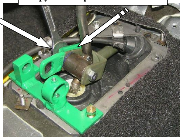
Установить хомут на рычаг, зафиксировать срывной гайкой
