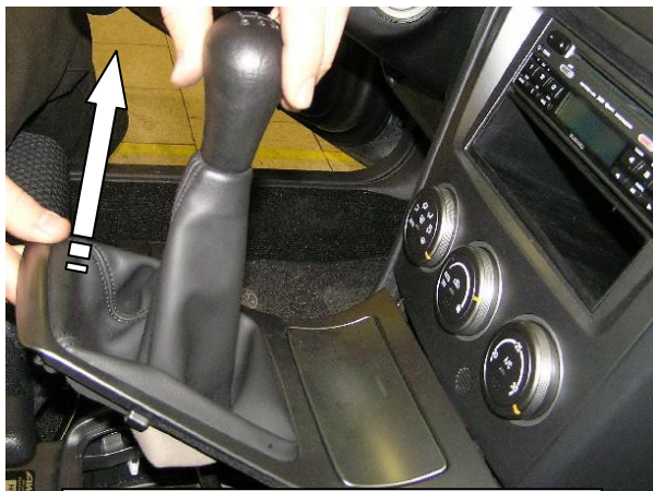
Снять декоративный чехол рычага переключения передач
