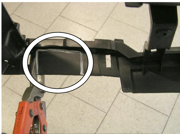
Удалить пластик консоли, мешающий установке замка
