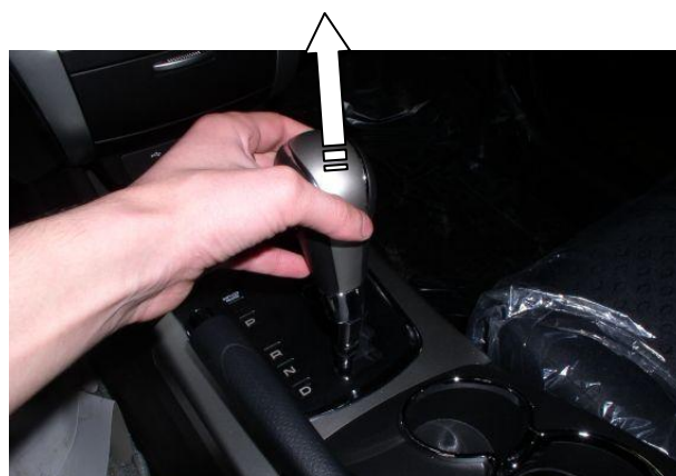
Снять рукоятку рычага переключения передач
