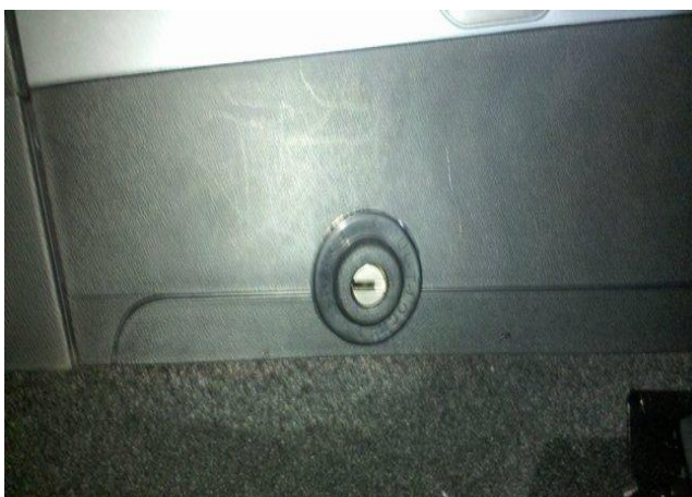
Разметить, используя разметочный шаблон, и просверлить отверстие в консоли под корпус замка, установить консоль на место
