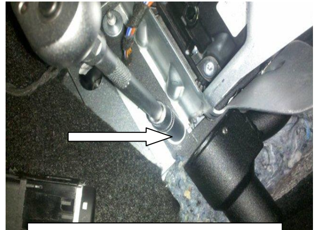
Открутить 3 гайки, установить замок, закрутить гайку
