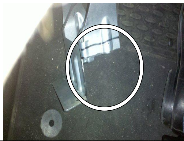
Удалить мешающий установке замка металл
