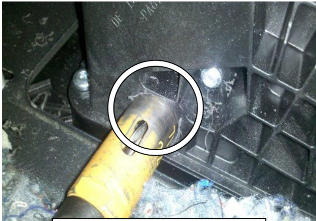
Просверлить отверстие в селекторе под трубу замка
