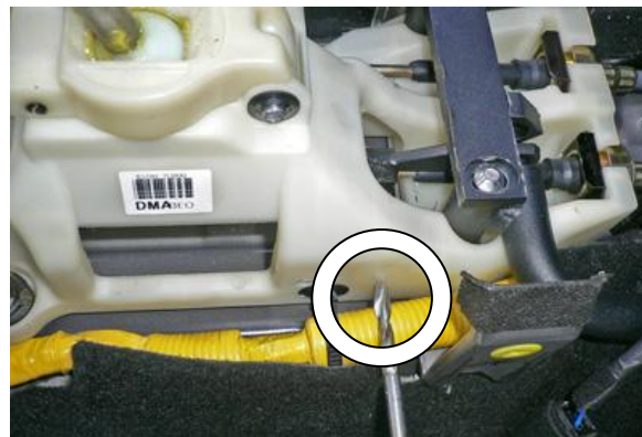
Просверлить технологическое отверстие в селекторе, перевести рычаг переключения передач в положение «R», произвести блокировку, отрегулировать положение хомута на тяге, зафиксировать хомут на тяге 2 винтами через технологическое отверстие
