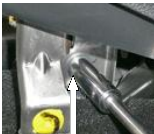
Зафиксировать лапку замка на стойке селектора срывным болтом
