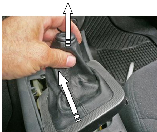
Открутить и снять рукоятку рычага переключения передач, снять декоративный кожух рычага
