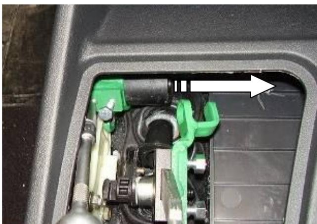
Просверлить и расширить отверстие под цилиндр, установить консоль на место, отрегулировать вылет цилиндра из консоли
