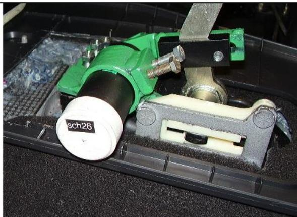
Разметить, используя разметочный шаблон, отверстие в консоли под цилиндр замка
