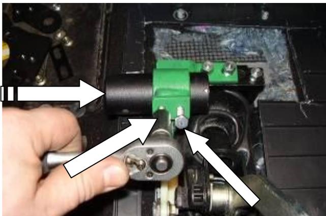
Установить цилиндр замка в кронштейн замка, зафиксировать 2 винтами
