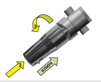
**4.** Потянув на себя блокиратор, извлечь его из основания корпуса. Разблокировка автомобиля завершена.
