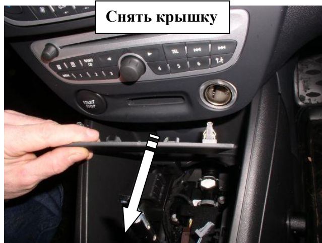
Снять боковую крышку
