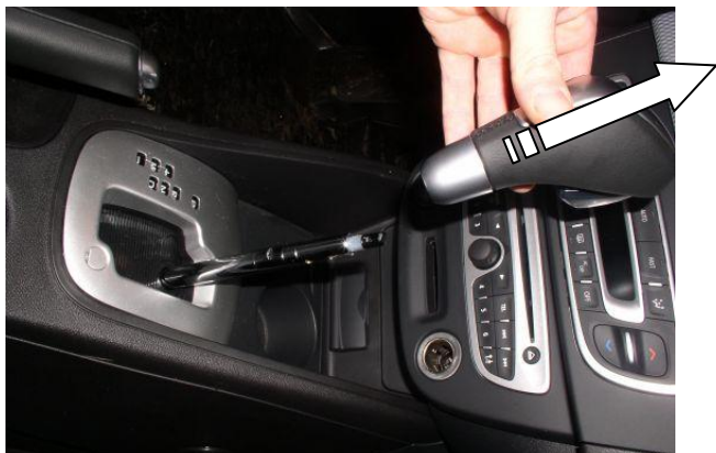
Снять рукоятку рычага переключения передач
