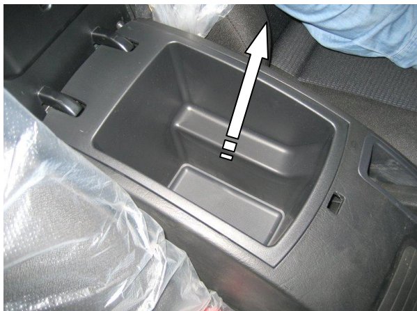
Поднять подлокотник, снять задний бункер
