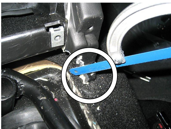
Удалить пластик, мешающий установке замка
