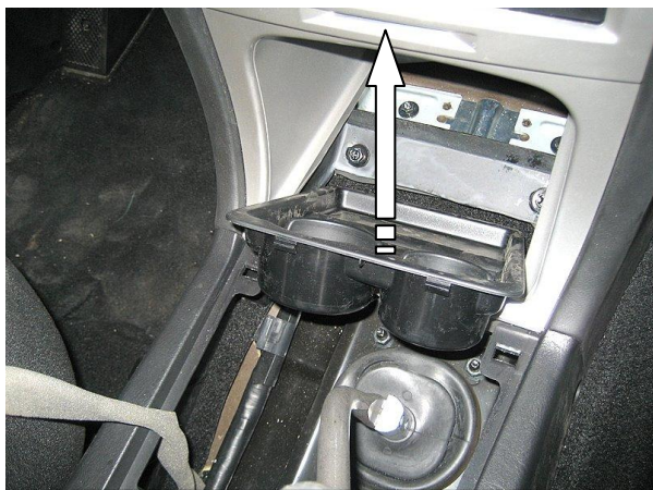
Снять блок подстаканников
