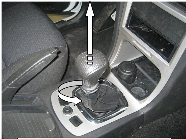
Открутить и снять рукоятку рычага переключения передач
