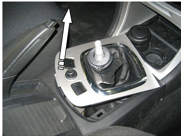
Снять верхнюю крышку с декоративным чехлом рычага переключения передач
