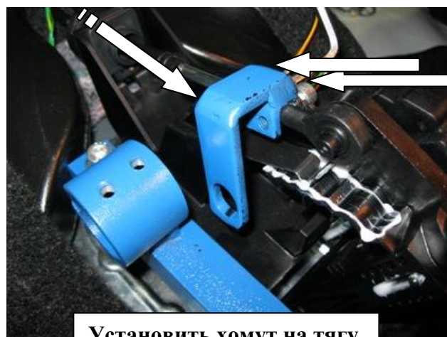
Установить хомут на тягу, зафиксировать 2 винтами
