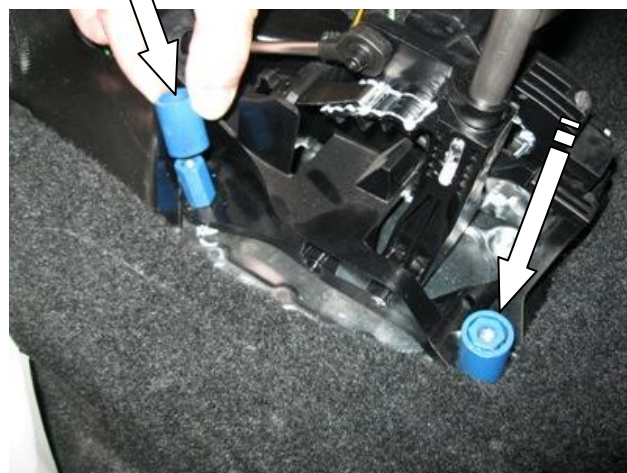
Установить шестигранные столбики на шпильки и цилиндры защиты на столбики
