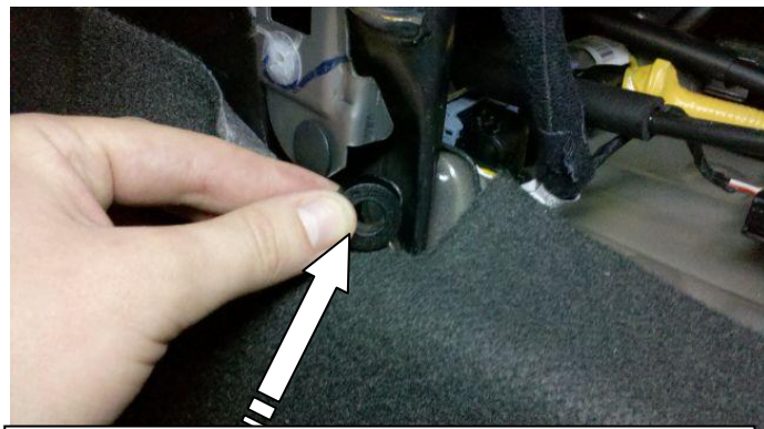
Открутить болт, подложить столбик 10 мм.
