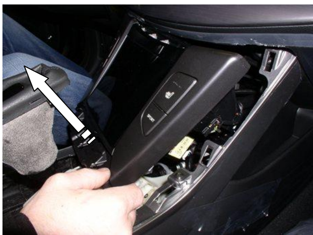
Снять переднюю крышку
