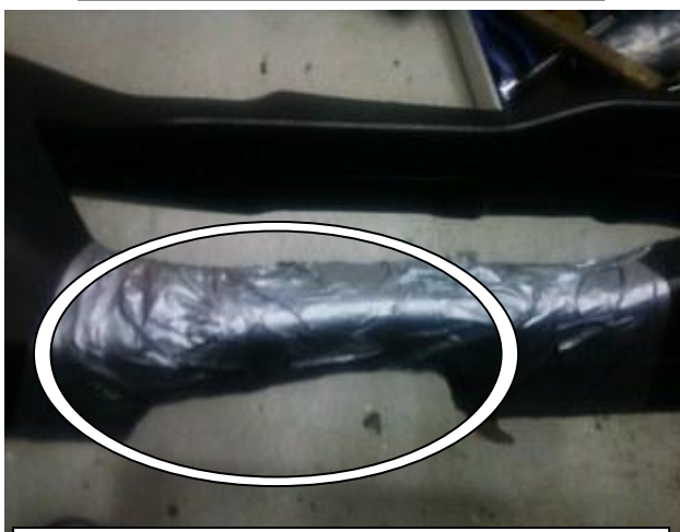
Удалить мешающую установке замка часть воздуховода, загерметизировать отверстие скотчем
