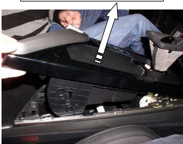
Снять верхнюю панель
