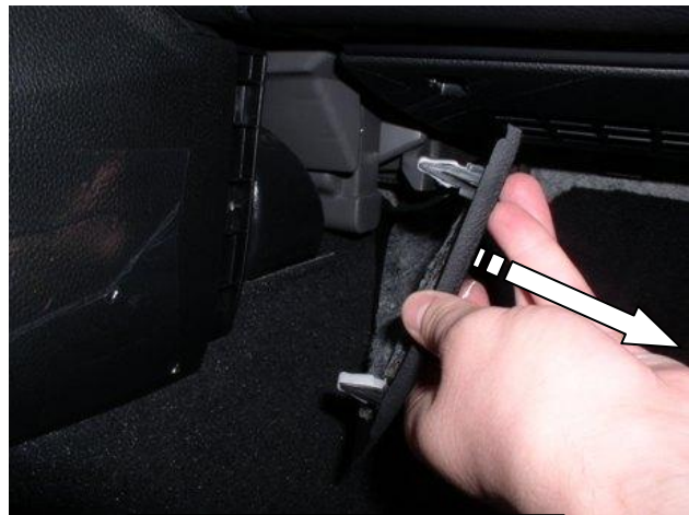
Снять боковую крышку
