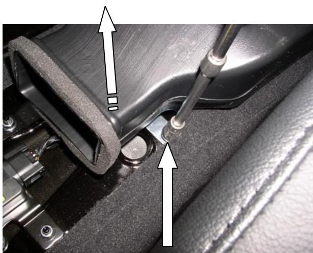
Открутить саморез, снять воздуховод
