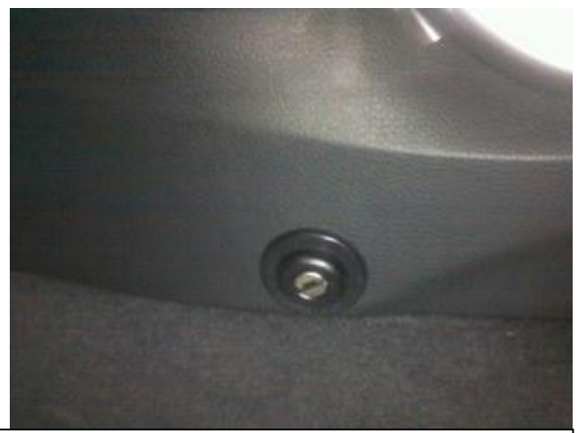
Разметить, используя разметочный шаблон, и просверлить отверстие в консоли под корпус замка, установить консоль на место
