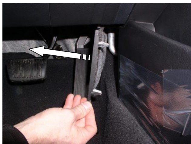
Снять боковую крышку
