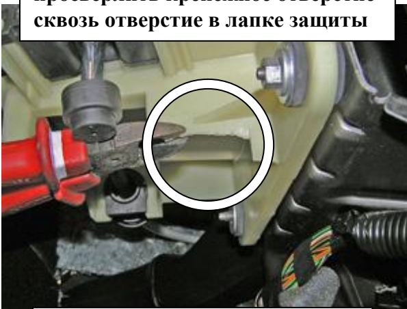
Удалить мешающий установке замка пластик селектора
