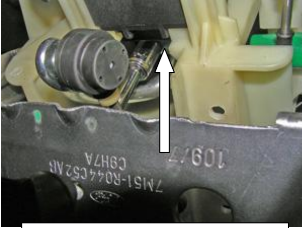
Закрутить 3 штатные гайки на 3 свободные шпильки селектора
