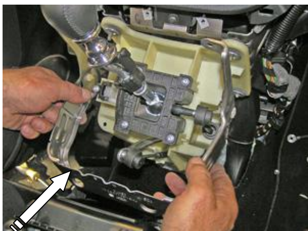
Установить держатель консоли на место
