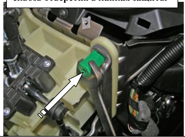
Установить шестигранный столбик на шпильку
