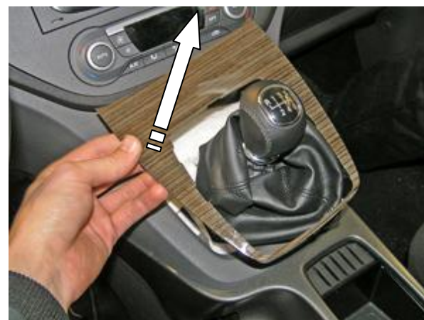
Снять верхнюю крышку
