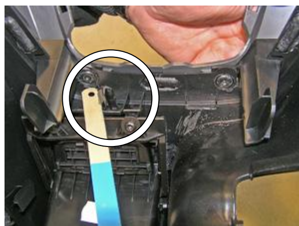
Удалить мешающий установке замка пластик консоли
