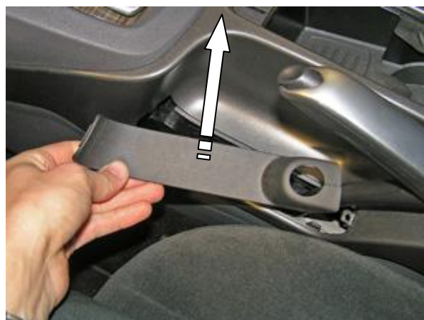
Снять крышку рычага стояночного тормоза
