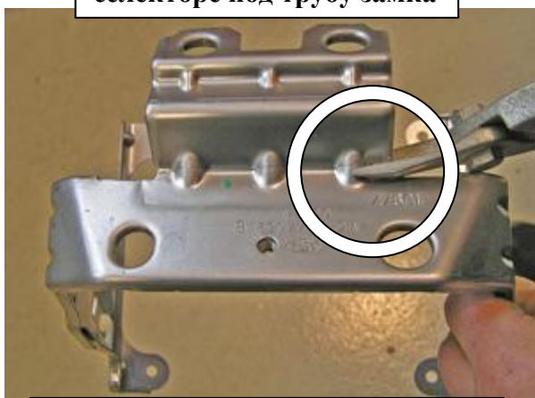
Удалить мешающий установке замка металл держателя консоли
