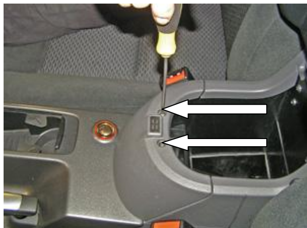
Поднять подлокотник, открутить 2 самореза
