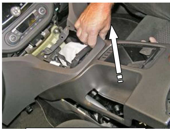
Снять переднюю консоль
