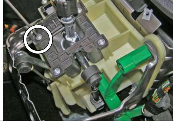
Сорвать шлицы винтов крышки селектора
