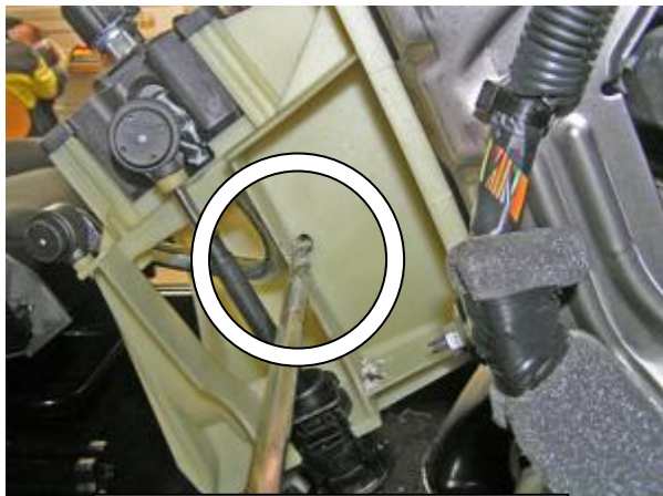
Просверлить отверстие в селекторе под трубу замка
