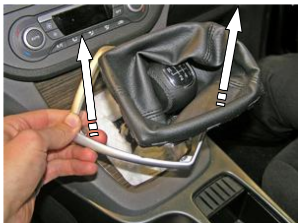
Снять декоративный чехол и планку рычага переключения передач
