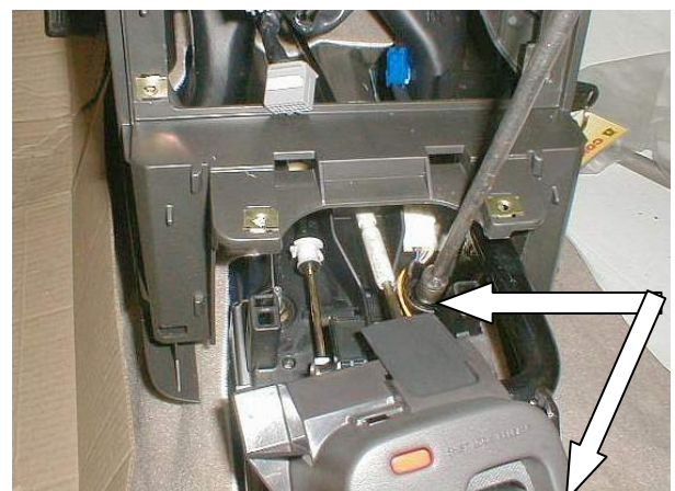
Установить замок на шпильки, закрутить 2 срывных гайки, перевести рычаг в положение «Р», проверить блокировку
