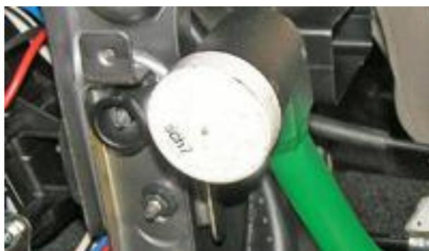
Разметить отверстие в консоли под корпус
