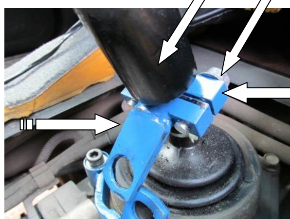
Установить хомут на рычаг переключения передач, зафиксировать 2 болтами
