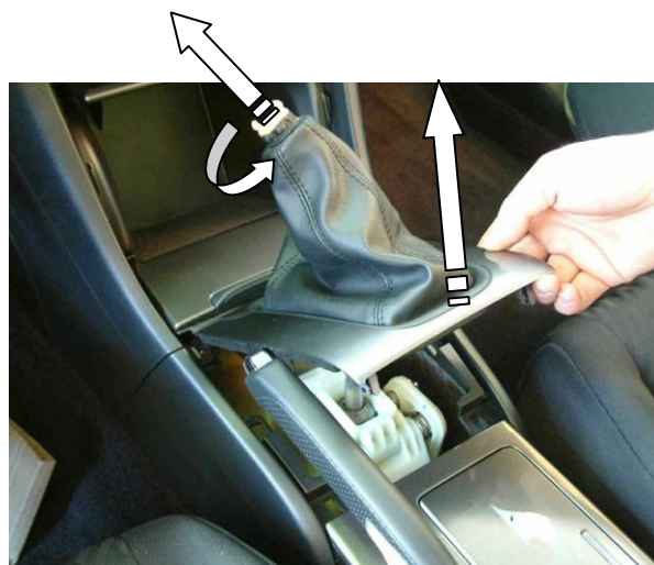
Открутить и снять рукоятку рычага переключения передач, снять декоративный кожух рычага переключения передач
