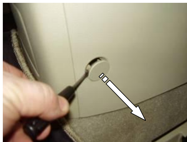
Сдвинуть передние сидения вперёд, вынуть заглушки с обеих сторон
