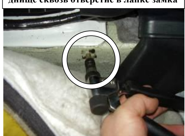
Установить резьбовую заклёпку в отверстие, используя клёпальник
