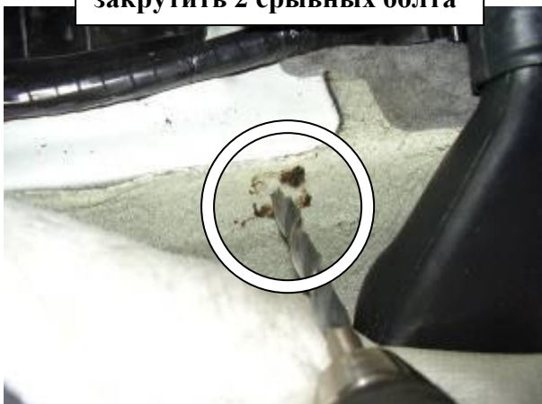
Снять замок, расширить отверстие до 9 мм.
