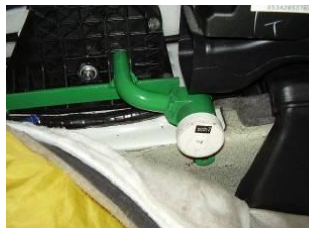
Расширить, используя разметочный шаблон, просверлить и расширить отверстие в ковровине под корпус замка
