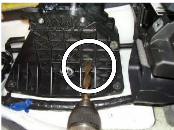
Просверлить отверстие в селекторе под ригель замка
