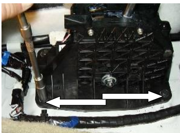
Открутить 2 штатных болта селектора
