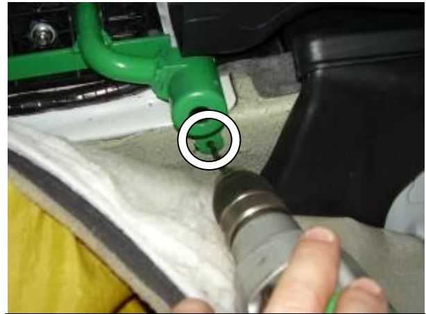
Просверлить крепёжное отверстие в днище сквозь отверстие в лапке замка
