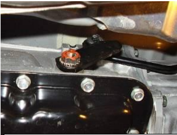
Заменить штатный болт на срывной
