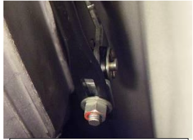
Заменить штатный болт на срывной
