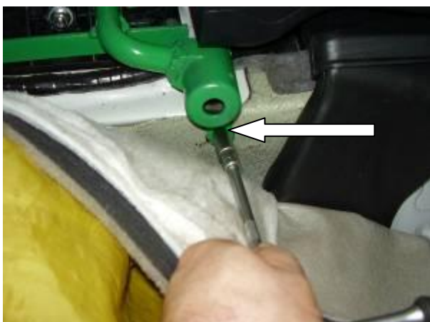
Вернуть замок на место, зафиксировать лапку срывным болтом
