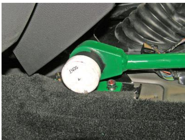
17 Разметить, используя разметочный шаблон, отверстие в консоли под корпус замка
