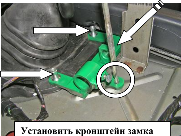
Открутить 2 штатные гайки
