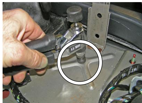
Открутить 2 гайки, снять кронштейн замка, установить в отверстие резьбовую заклёпку с помощью клёпальника
