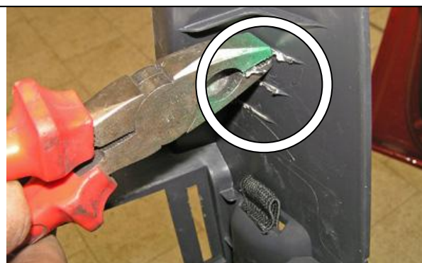
16 Удалить мешающие рёбра жёсткости консоли
