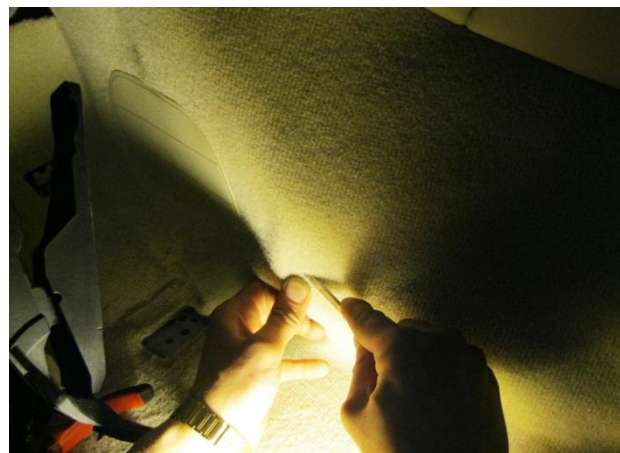
Вырезать отверстие в ковровине под цилиндр замка
