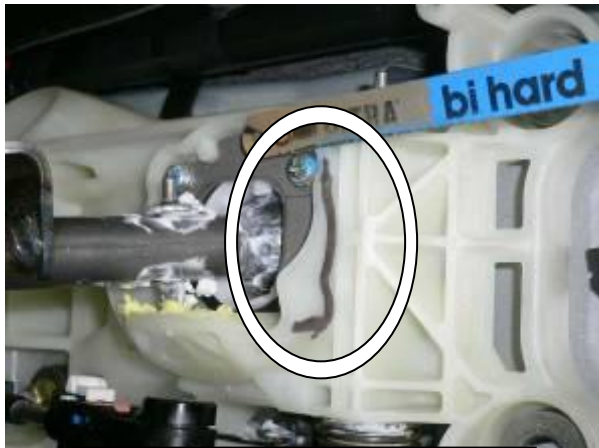
Удалить пластик селектора, мешающий установке замка
