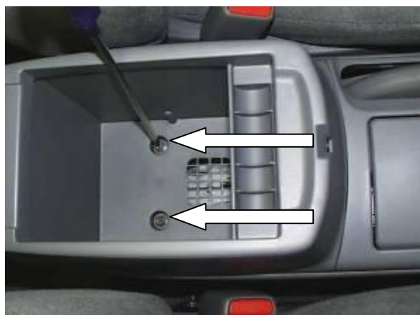
Поднять подлокотник, открутить 2 самореза
