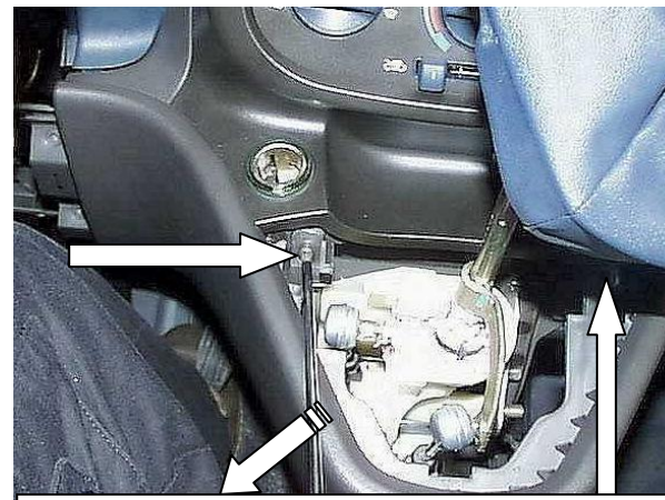
Открутить 2 самореза, снять консоль
