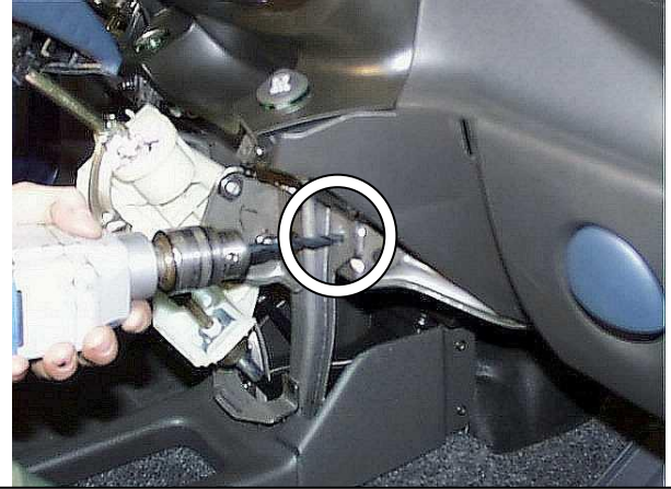
Расширить отверстие в стойке до 9 мм.
