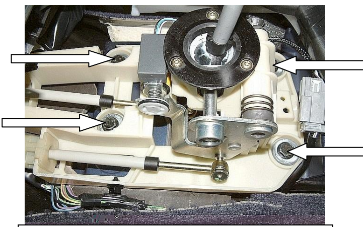
Открутить 4 штатных болта селектора
