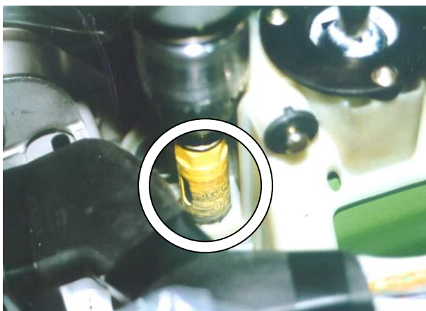
Открутить болты, снять кронштейн, расширить отверстие до 22 мм.
