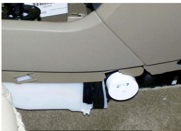
23 Установить разметочный шаблон на корпус замка
