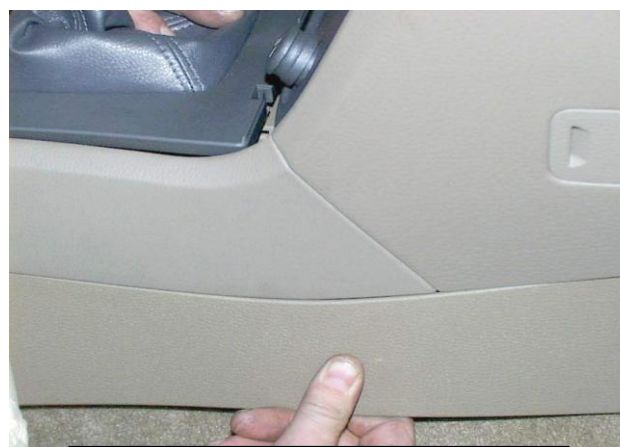
24 Разметить отверстие в боковой крышке под корпус замка
