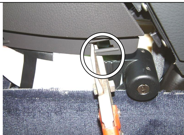
22 Установить консоль на место, удалить мешающий замку пластик
