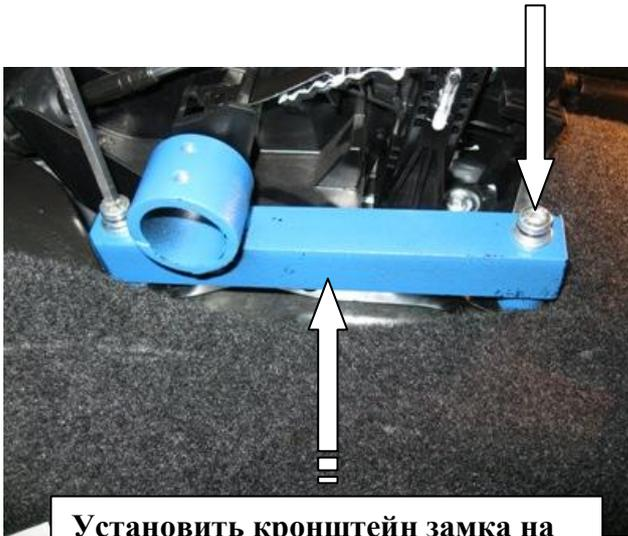
Установить кронштейн замка на столбики, закрутить срывной болт
