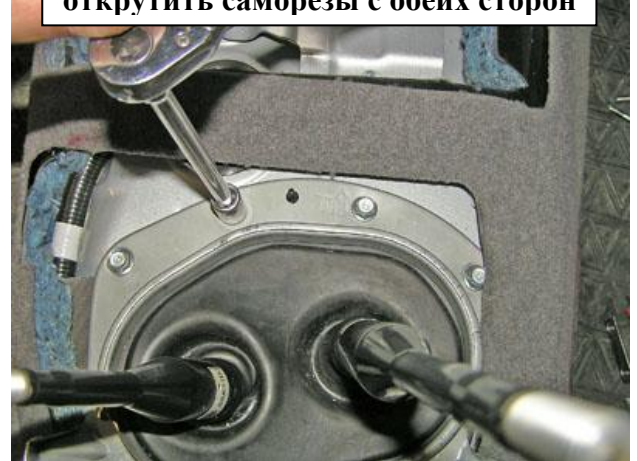
Сдвинуть передние кресла вперёд, открутить саморезы с обеих сторон 8
