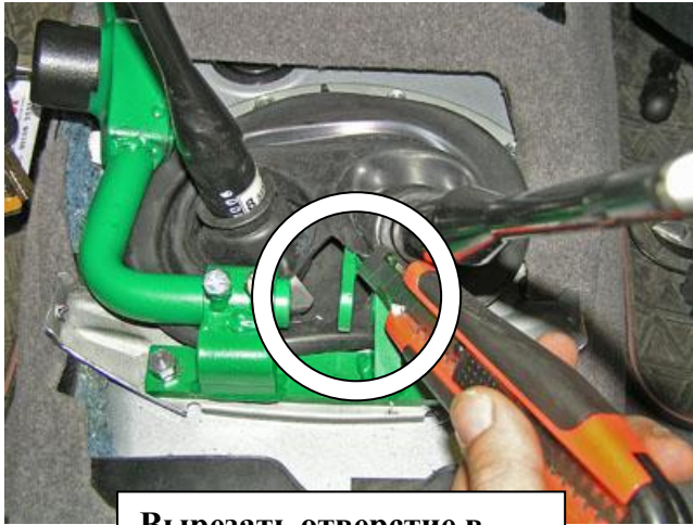
Вырезать отверстие в звукоизоляции под хомут
