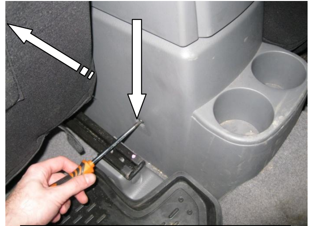
Сдвинуть передние кресла вперёд, открутить саморезы с обеих сторон 8
