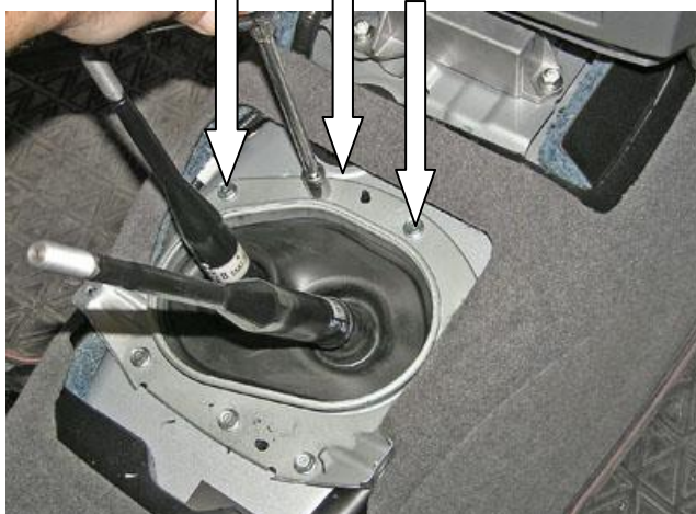
Открутить штатных 3 болта держателя консоли
