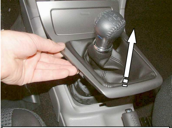
Снять крышку декоративного чехла рычага переключения передач
