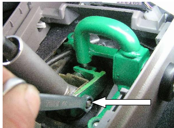
19 Зафиксировать хомут на рычаге срывной гайкой, перевести рычаг переключения передач в положение «R», произвести и 20 и проверить блокировку рычага, сорвать гайку
