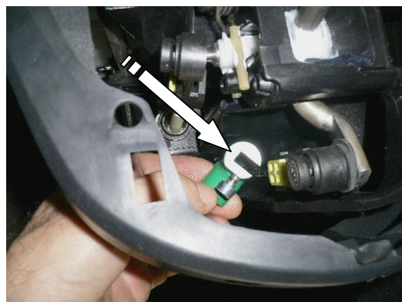
Установить хомут на тягу
