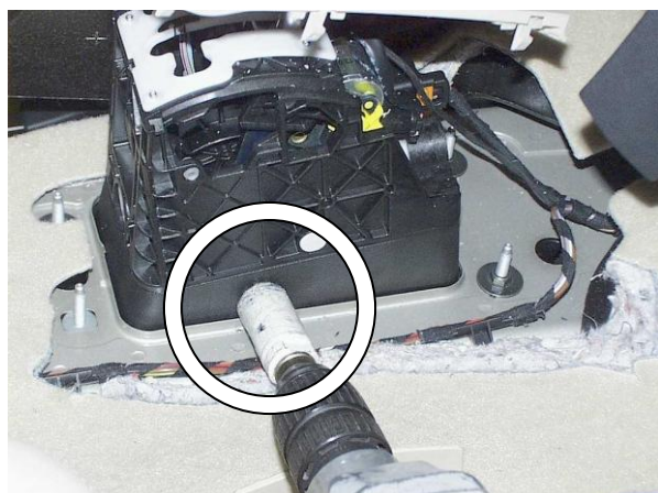
Расширить отверстие до 22 мм.
