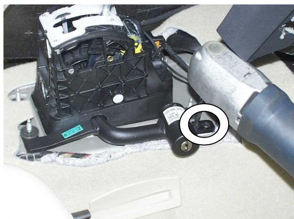
Просверлить 2 крепёжных отверстия в днище сквозь отверстия в лапке замка
