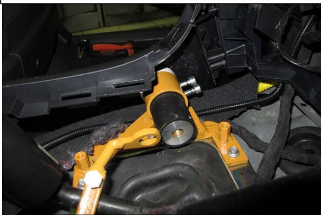
Разметить отверстие в консоли под прямоходный цилиндр
