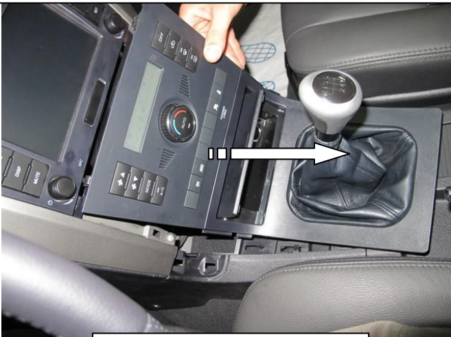
3 Снять переднюю панель
