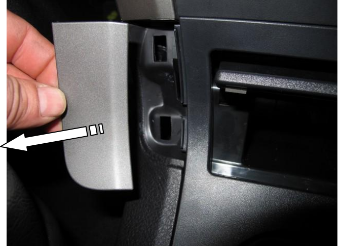
2 Снять декоративные панели с обеих сторон
