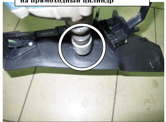
Просверлить и расширить отверстие
