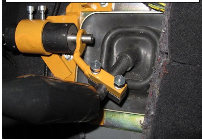
Перевести рычаг переключения передач в положение «R», произвести блокировку, при необходимости отрегулировать положение хомута на рычаге, сорвать болты
