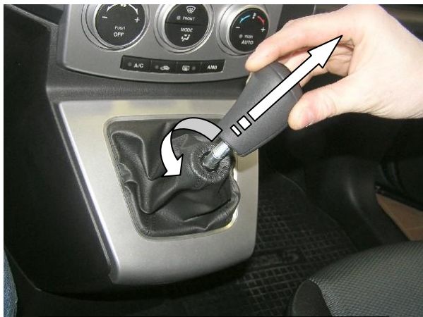
Открутить и снять рукоятку рычага переключения передач
