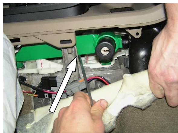
Перевести рычаг переключения передач в положение «R», произвести блокировку, отрегулировать положение хомута на тяге, сорвать винт
