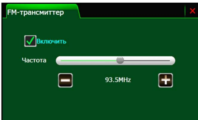
FM-передатчик посылает аудиосигнал на автомагнитола или другое радиоустройство с FM-диапазоном. Например, если выставить на Навигаторе частоту 93,5 МГц и принимающее устройство настроить на эту же частоту, то все звуковые сигналы Навигатора будут транслироваться через усилитель радиоустройства. Встроенный динамик Навигатора при этом отключается.
