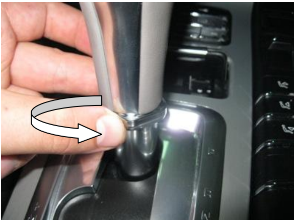
Открутить стопорное кольцо рукоятки
