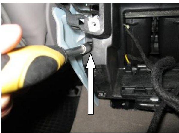
Открутить 2 самореза с обеих сторон
