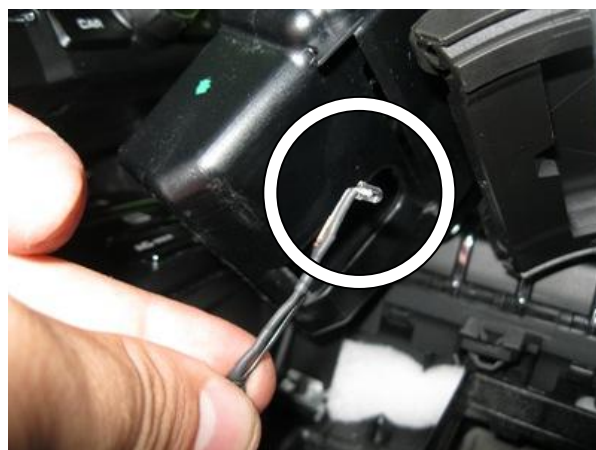
Осторожно отсоединить светодиод
