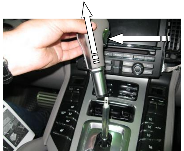
Снять рукоятку рычага, не нажимая кнопку!!!
