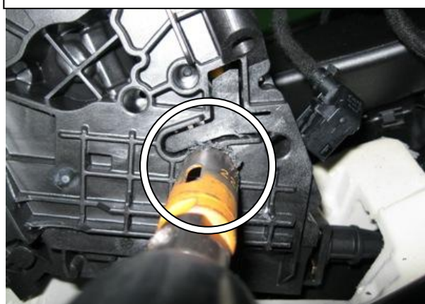
Снять шаблон, расширить отверстие до 22 мм.
