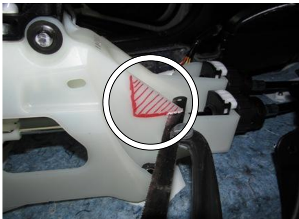
Удалить мешающий пластик селектора
