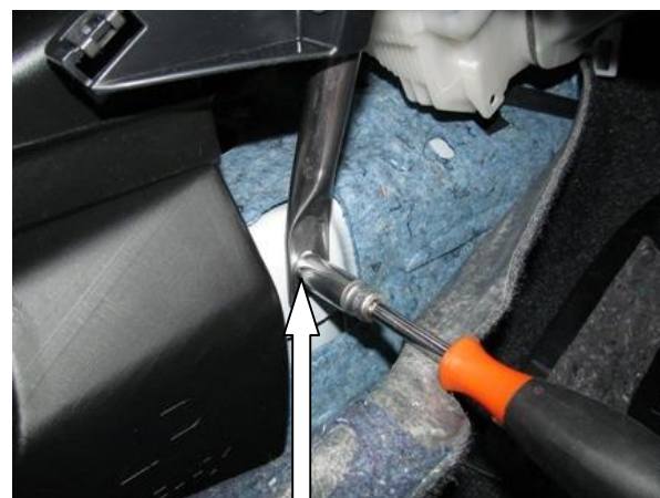
Открутить штатный болт селектора
