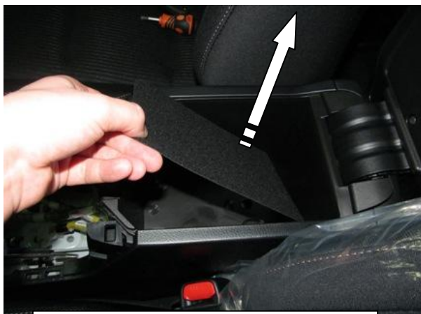
Поднять подлокотник, вынуть декоративную прокладку
