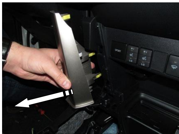
Снять декоративную планку
