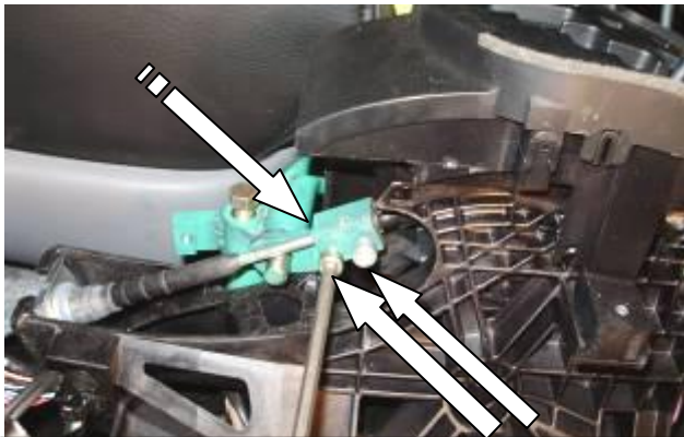
Установить хомут на тягу, зафиксировать 2 винтами, перевести рычаг переключения передат в положение «Р», произвести блокировку, отрегулировать положение хомута на тяге, сорвать винты
