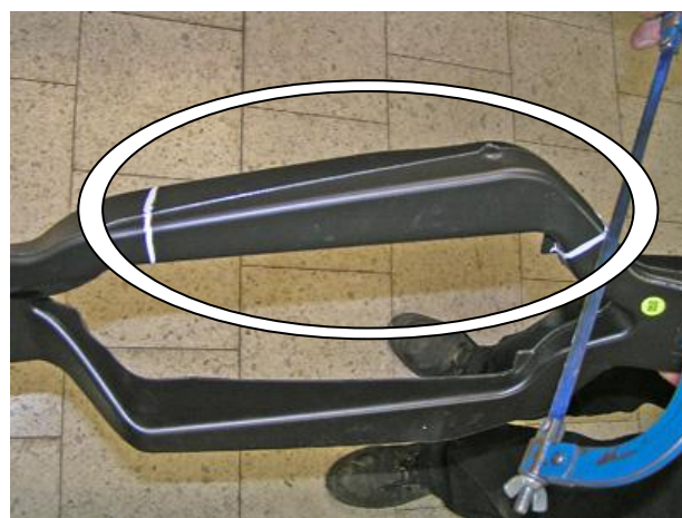
Удалить мешающий пластик воздуховода
