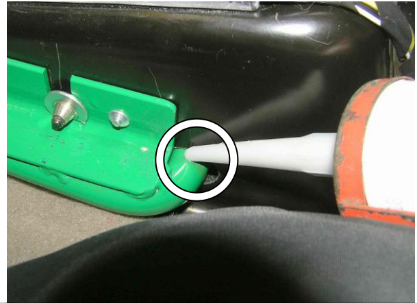
Загерметизировать отверстие в стенке тоннеля с помощью герметика
