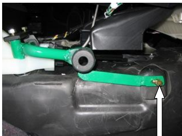
Зафиксировать лапку замка срывным болтом
