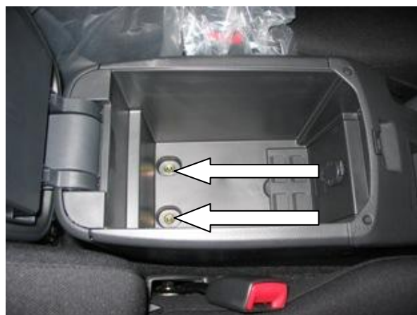
Поднять подлокотник, открутить 2 самореза
