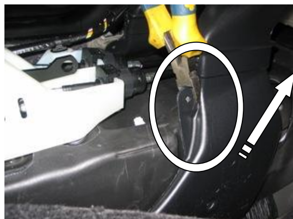
Удалить часть воздуховода
