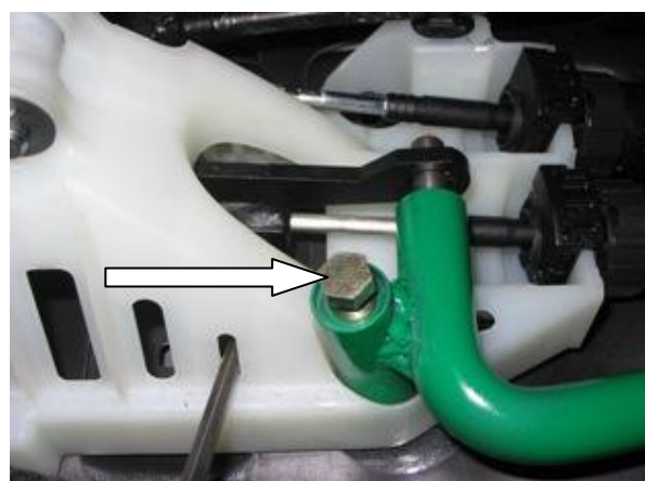
Установить замок, закрутить болт (не срывать !!!), перевести рычаг переключения передач в положение «R», произвести блокировку, отрегулировать положение хомута на тяге
