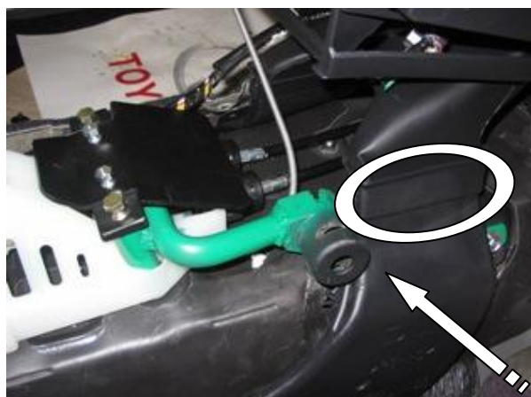
Вернуть воздуховод на место, загерметизировать разрез изолянтной
