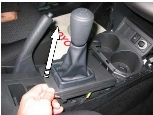
Снять крышку декоративного чехла рычага переключения передач
