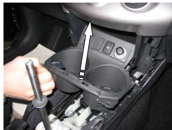
Снять блок подстаканников
