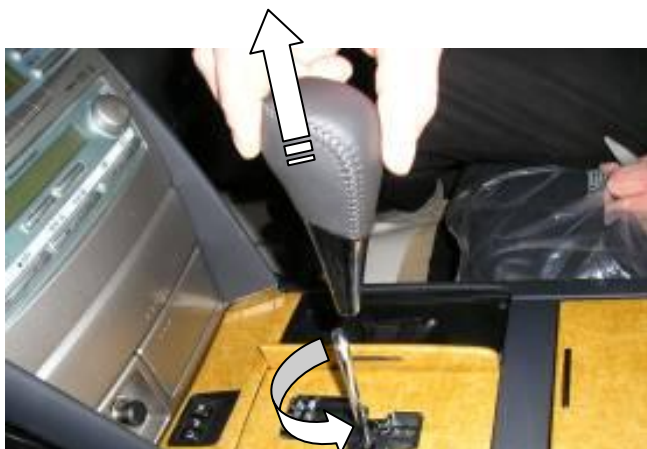
Открутить и снять рукоятку рычага переключения передач
