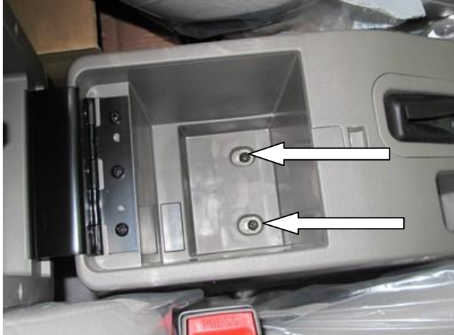
1 Поднять подлокотник, открутить 2 самореза
