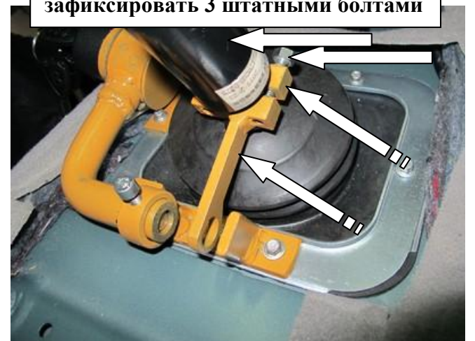
6 Установить хомут и ответную часть на рычаг переключения передач, зафиксировать 2 срывными болтами (не срывать!!!)
